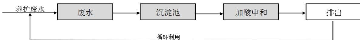
图 7.1.2-2 养护废水处理工程示意图
