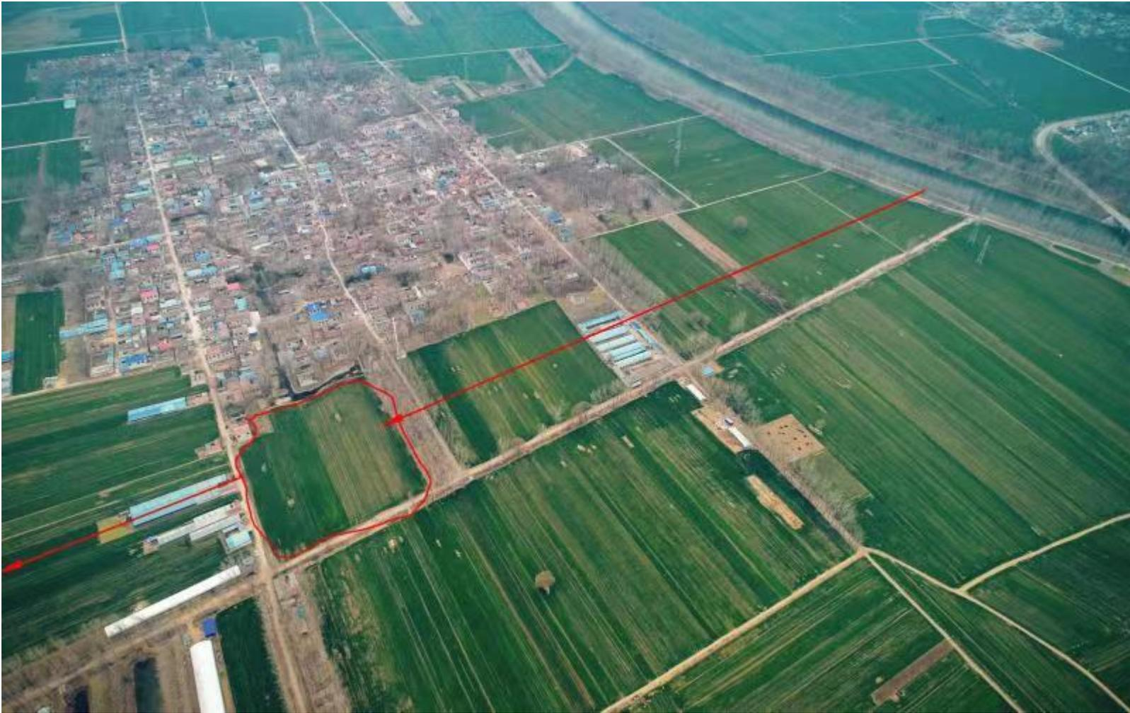
图 3.1.2-1 取水口、泵站、箱涵位置关系图
